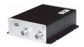
Декодер STS-IPD 160 осуществляет декомпрессию и преобразование в аналоговую форму видеосигнала в формате MPEG4-ASP, поступающего с видеосервера или IP-камеры Smartec, и передает полученный видеосигнал на аналоговое оборудование для видеонаблюдения: видеомонитор, видеорегистратор с аналоговыми входами или матричный коммутатор. STS-IPD 160 в сочетании с видеосервером может использоваться для передачи видеосигнала на большие расстояния посредством LAN/WAN.
